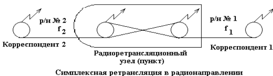
Рис. 9. Связь при симплексной ретрансляции
